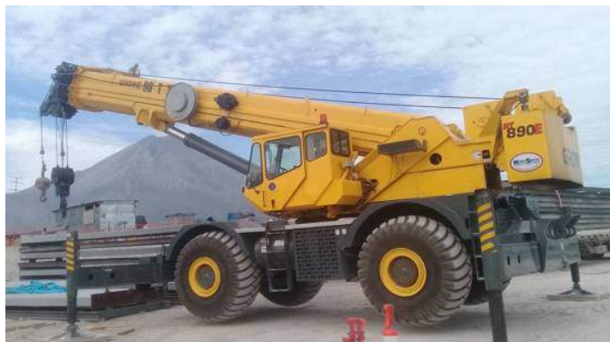
• GRÚA GROVE • 148 ft • 56 ft Aguilon •
