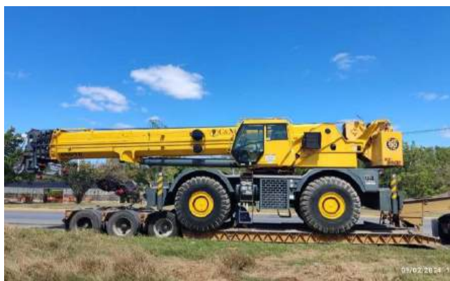
• GRÚA GROVE • 148 ft • 56 ft Aguilon •
